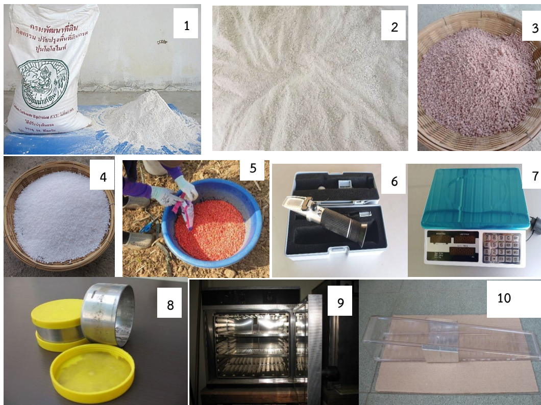
ภาพที่ 1 วัสดุและอุปกรณ์สำคัญที่ใช้ในการทดลอง 1. โดโลไมต์ 2. สารเอ็ม เค 3. ปุ๋ยเคมี 4. ยูเรีย 5. เมล็ดพันธุ์ข้าวโพดหวาน 6. hand refractometer 7. เครื่องชั่งดิจิตอล 8. soil core sampler 9. oven dried 10. กระบอกเก็บปริมาณน้ำฝน
